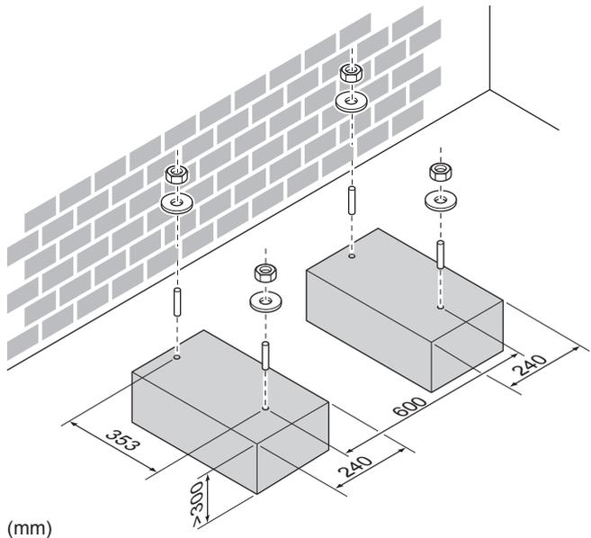
U svakom slučaju, obezbedite najmanje 300 mm slobodnog prostora ispod jedinice. Pored toga, proverite da li je jedinica postavljena najmanje 100 mm iznad maksimalne očekivane visine snega. U tom slučaju se preporučuje konstruisanje postolja.
