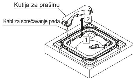
(3) Sa kukice na ploči otkačite kabl za sprečavanje pada kutije za prašinu.
