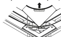
(2) Odvijte vijke na zadnjoj strani ugaonog ukrasnog poklopca (sa displejem), otvorite poklopac i uklonite konektor koji je prikraćen za prednje krajeve provodnika sa štampane ploče.
