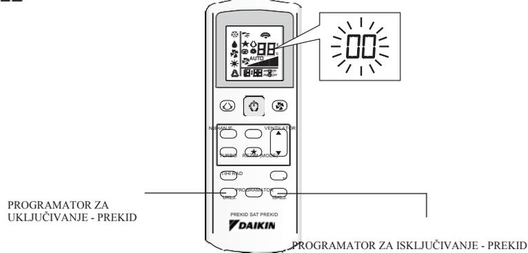
2. Pritisnite na dugme **PROGRAMATOR ZA UKLJUČIVANJE - PREKID (ON TIMER CANCEL)** ili **PROGRAMATOR ZA ISKLJUČIVANJE - PREKID (OFF TIMER CANCEL)** više puta sve dok se ne začuje kontinualni zvučni signal (bip).
